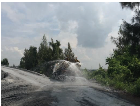
รูปที่ 2-12: การฉีดพรมน้ำบริเวณหน้าเหมือง
